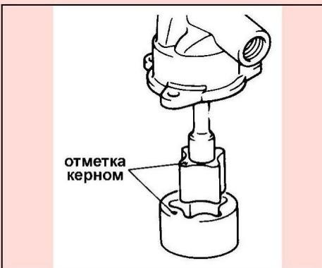
2. Установить крышку масляного насоса (маслоприемник) и закрепить ее тремя болтами (M.3. = 7,8 Н·м).
