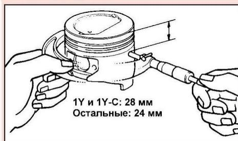
б) Подсчитать размер каждого цилиндра. Размер под расточку = Р+С-Н
